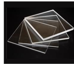
Famoso plástico utilizado en innumerables aplicaciones. Soporta la exposición a rayos ultravioletas sin dañar su color y estructura. No se astilla, es resistente en comparación al vidrio. Su peso es inferior al del vidrio. Además de ser termoformable, puede ser lijado, taladrado (con una broca especial), doblado con calor, etc. Usado comunmente para anuncios, exhibidores, domos, envases, piezas de joyería, etc.
